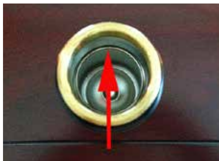
Abb. 2: Behälter darf nur bis zu 85 % gefüllt werden.
