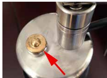
Abb. 3: Auslassventil nicht berühren.
